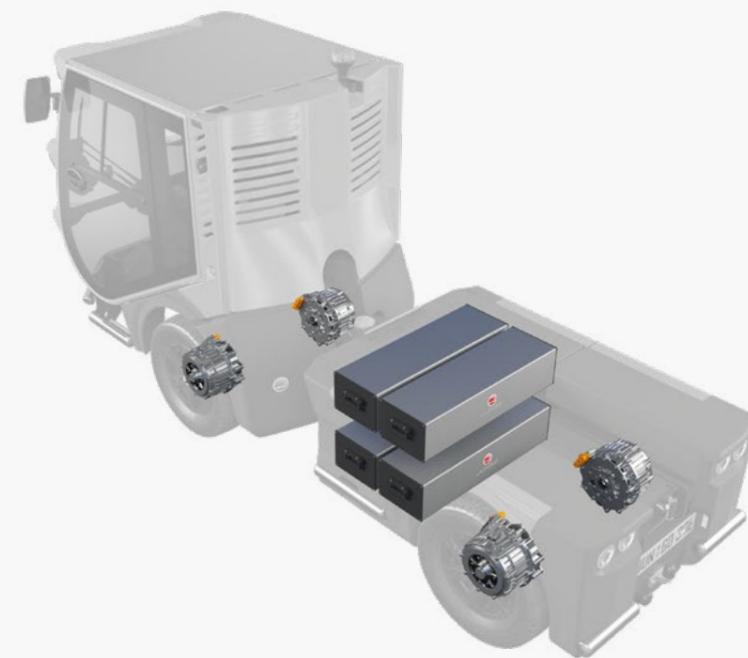
48V-Jungo-Powerpacks und Elektro-Radnabenmotor-Allradantrieb
